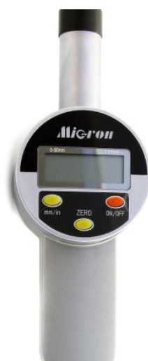
Рис. 4. Внешний вид прибора Micron ИЦ 0-50 0.01, с цифровым дисплеем считывания и тремя функциональными кнопками.
